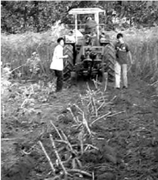
Hình 107: Máy đào nhỏ củ sắn do Học viện Nông nghiệp nghiên cứu thiết kế
