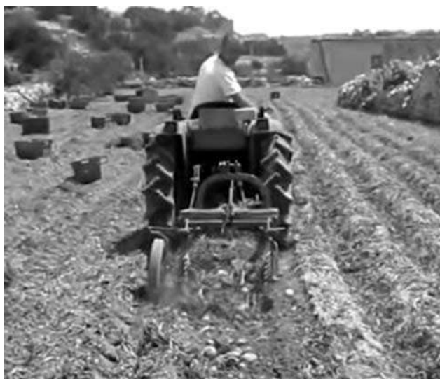
Hình 81: Máy đào khoai tây kiểu sàng lắc
